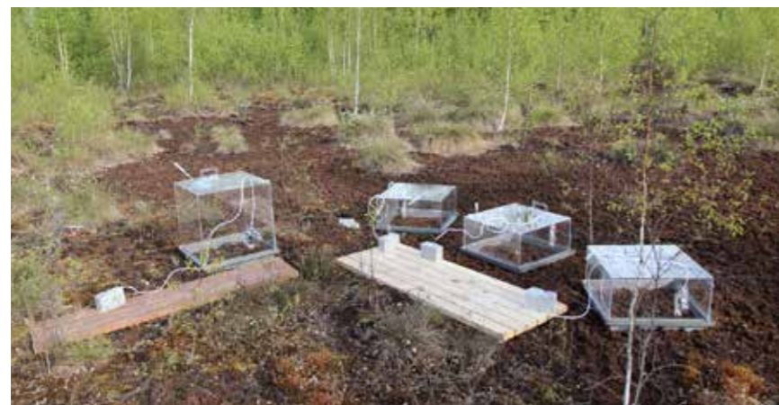
Камерные измерения потоков парниковых газов на полигоне «Росьянка»
