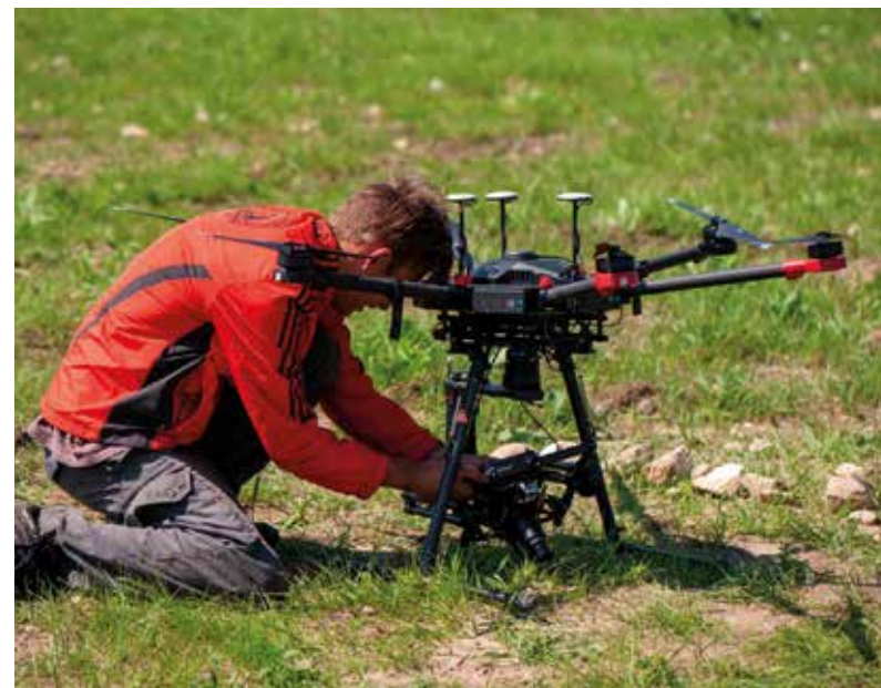
Подготовка БПЛА к съемке с гиперспектральной камерой
